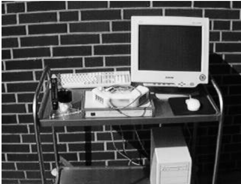
Abb. 2: Die Meßeinheit spiroson scientific mit Personal Computer
