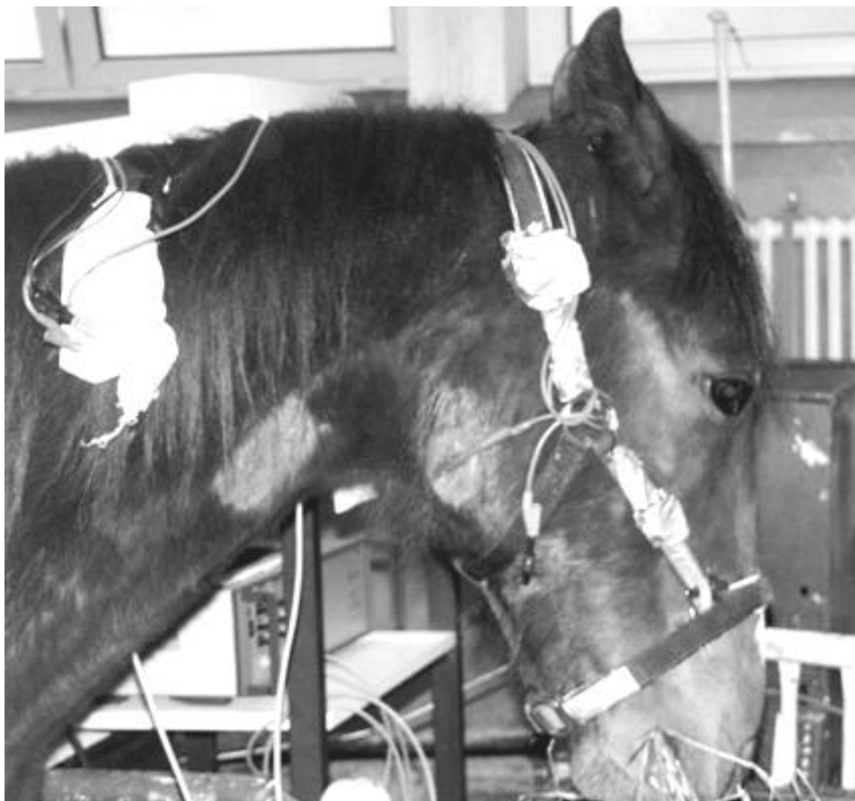
Abbildung 4: Darstellung der Elektrodenplatzierung zur Myografiemessung beim Pferd
