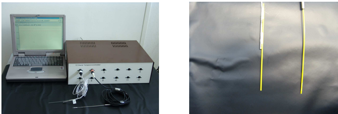
Abb. 3.4: 12 Kanal-Temperaturschreiber mit Notebook (links) und Temperaturfühlern, die neben und in der Paillette positioniert waren (rechts).
