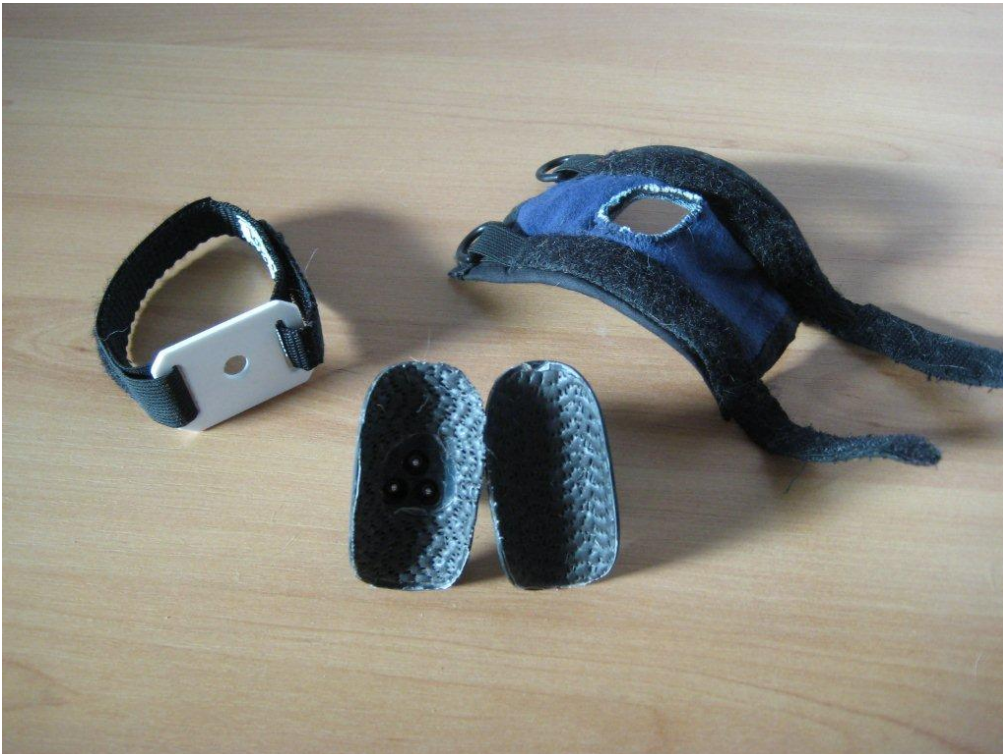
Abbildung 4: Manschette für die Vordergliedmaße mit Befestigungshilfe. Im Vordergrund rechts Dummyaufsatz, links mechanisches Teil zur Stimulation mit den drei Pins.
