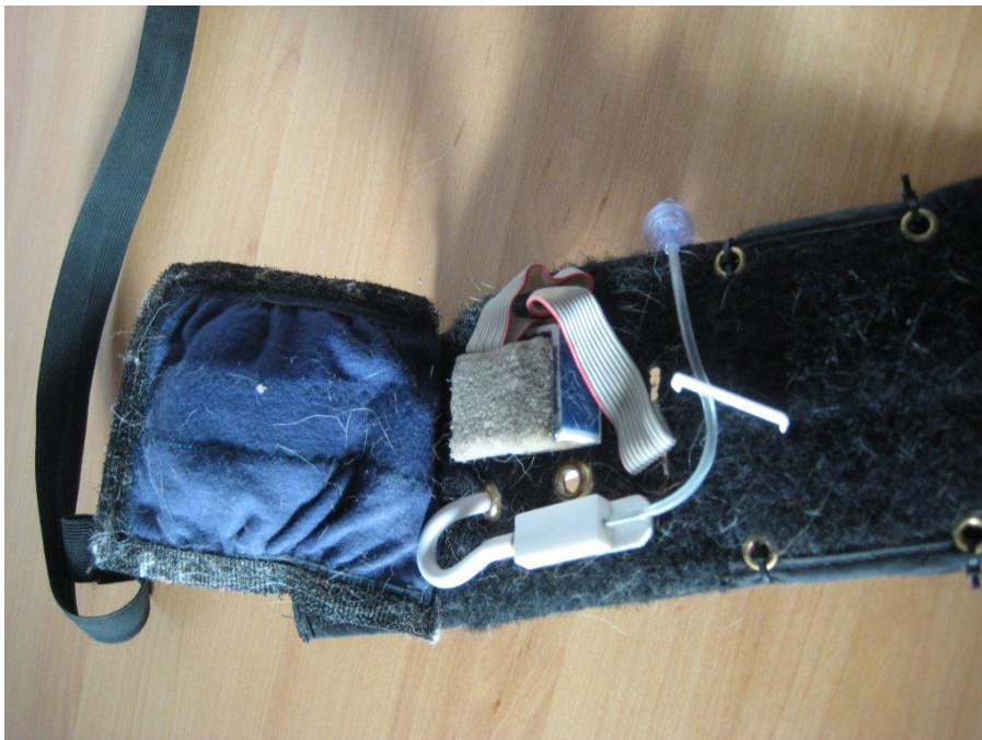
Abbildung 2: Außenseite der Manschette, nach links ist der Überzug zum Schutz der Kabel abgeklappt. Durch den Schlauch wird Luft in das Kissen gefüllt. Damit die Luft nicht
