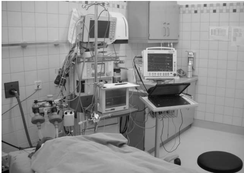
Abb. 5: Versuchsaufbau zur Bestimmung der MAC. Im Vordergrund liegt der Hund unter einer Wärmeluftdecke. Das verwendete Anästhesiegerät ist mittig zu erkennen, vor ihm befindet sich der Monitor zur Aufzeichnung der Hirnstromkurven. Rechts daneben steht der Multiparameteranästhesiemonitor, vor ihm befindet sich ein Laptop zur Datenspeicherung. Der Nervenstimulator ist nur teilweise am unteren linken Bildrand zu erkennen.
