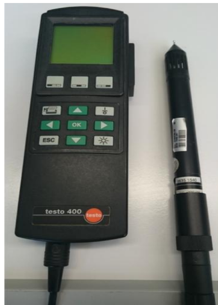
Abbildung 3.1: Multifunktionsmessgerät testo 400 (testo AG, Lenzkirch, Deutschland) zur Bestimmung von Temperatur, Luftfeuchte und Luftgeschwindigkeit
