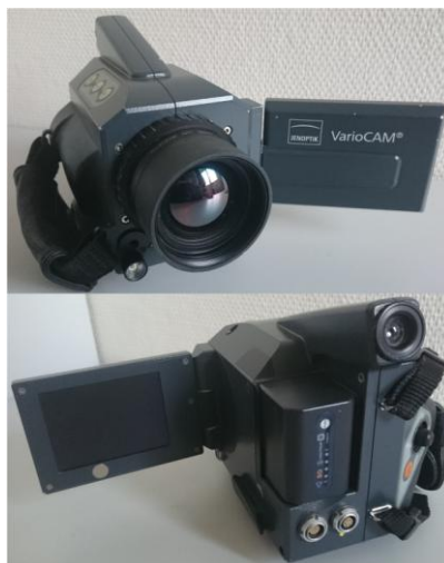
Abbildung 3.5: High resolution inspect Infrarotkamera (VarioCAM ® , Infratec GmbH, Dresden, Deutschland)
